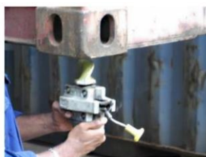
图 1-1：集装箱码头工人解除锁扣的工序
