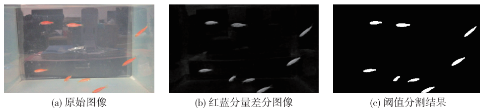
图 1 红蓝分量差分法对运动目标的检测结果
