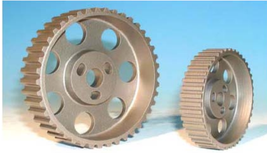
图 1-4 SLM 成型的齿轮 [2]
