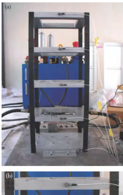
图 1 4 层剪切框架试验模型
