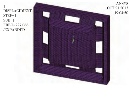
图5 一阶振动模态 Fig. 5 1 st vibration mode shape
