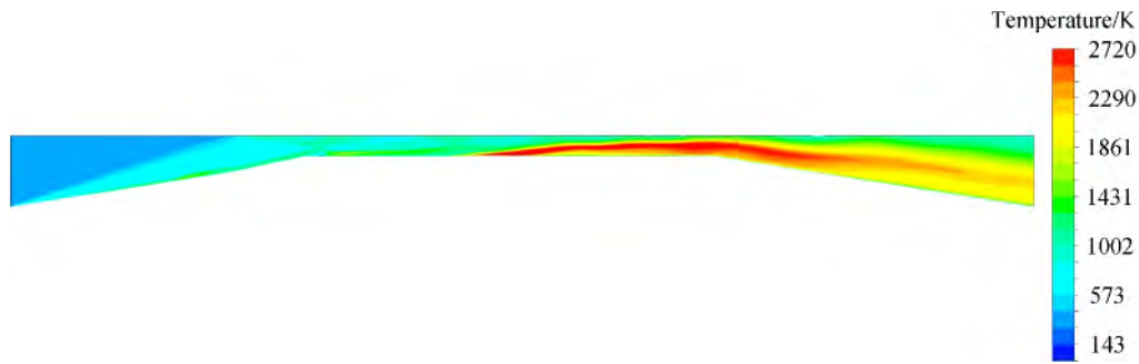
图 8 对称面温度分布云图
