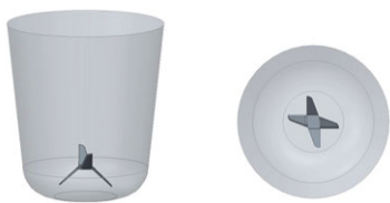
图1 简化后的榨汁机几何模型
