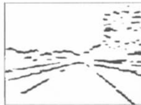
图 4 经方向滤波后的二值图像
